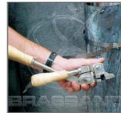
**4** - Ajuste as alavancas do aparelho para a posição de trabalho, e alinhe o canal da fita no eixo com o canal da faca.
