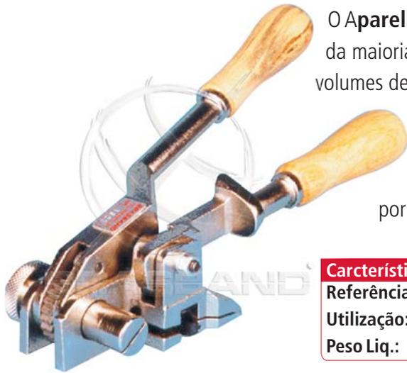
O **Aparelho B-01**, conhecido nacionalmente como Máquina Eriband, ao contrário da maioria dos aparelhos de arquear, possibilita esticar e cortar fitas de aço sobre volumes de quaisquer formatos, redondos, sextavados, quadrados, etc. É dotado de prático e eficiente sistema de catraca, que facilita o esticamento da fita de aço durante o trabalho de cintar o poste ou arquear a embalagem. Suas lâminas de aço especialmente tratadas garantem um corte eficiente por longo período.
