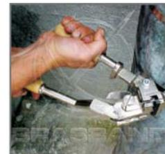
**8** - Acione a alavanca de corte (a menor), no sentido do poste ou objeto, cortando a fita.
