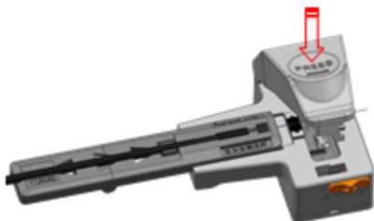
4. Após liberar a tampa, ela se abrirá automaticamente. Remova a fibra cuidadosamente do suporte, completando o processo de corte.
