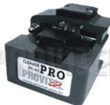
O **Clivador Mecânico de Precisão PRO PC-01** para corte de fibras ópticas SM e MM de 125µm de diâmetro nominal e revestimento de 250µm e 900µm, com ângulo de 90° ± 0,5°, e comprimento entre 5 a 20mm. Lâmina circular substituível de 16 posições, com vida útil maior que 48.000 clivagens.
